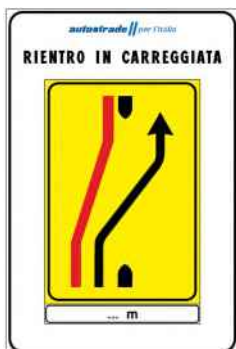
Pannello composito di informazione, modificabile con lamierini da installarsi nella corsia in deviata. Dimensioni 135*200 cm, su cavalletto.
