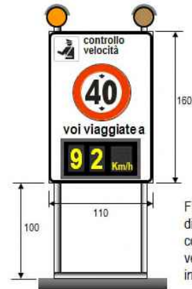
Figura 10: cartello di preavviso 90x135 da posizionare su cavalletto in anticipo rispetto alla posizione del box autovelox mobile
