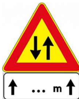
Cartello Fig. II 387 art. 31 con cartello integrativo modello II 2 art. 83 di estensione da installarsi sulla corsia non deviata
